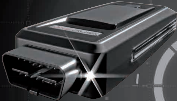
Funzione torcia per illuminare connettore OBD
